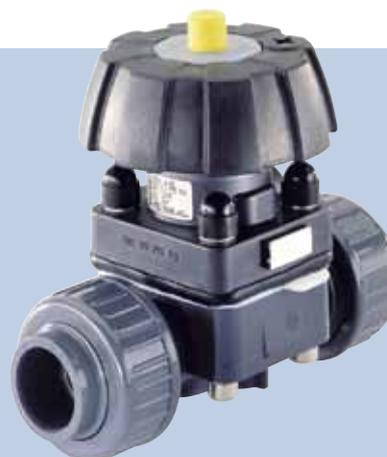
Valvola manuale a membrana per prodotti chimici aggressivi. Offre una lunga durata anche con fluidi contaminati, sporchi o ad alta viscosità. La membrana disposta tra l'attuatore e il corpo isola il fluido dall'attuatore e fornisce una tenuta ermetica sulla sede della valvola. Il comando manuale consente di utilizzare la valvola per chiusura di sicurezza e per regolazione.
