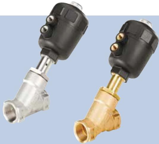
Classica valvola a sede inclinata Bürkert, concepita per una prestazione di lunga durata, sostituisce perfettamente le valvole a sfera. Configurate per il flusso sotto sede dei liquidi, queste valvole esenti da colpo d'ariete utilizzano un premistoppa a carico mobile e un attuatore a pistone con guarnizione N racchiusi in un'unica custodia compatta e robusta.
